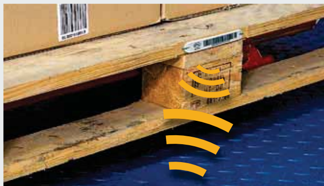
Usaldusväärne andmete ülekande kõige lühemat teed pidi RFID transponderi ja lugeja vahel.
