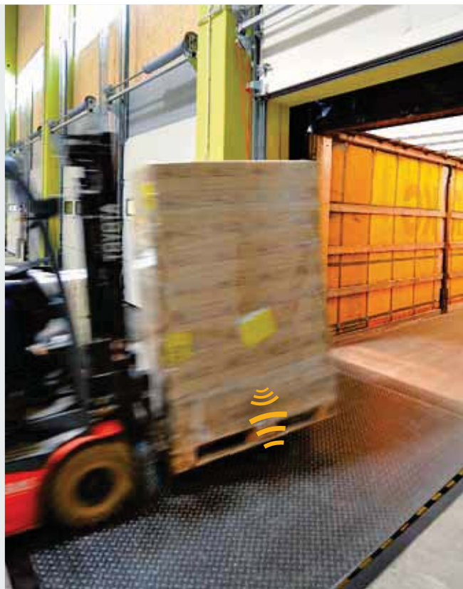
Kaupade liikumise automaatne tuvastus lihtsalt laadimissillast üle sõites
